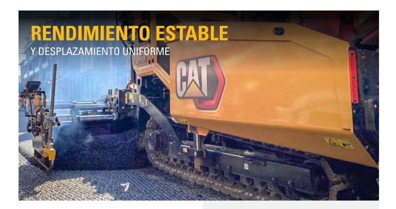
Los modelos de cadenas de acero ofrecen muchas de las magníficas características que se utilizan en las versiones Mobil-Trac con velocidades de desplazamiento ligeramente inferiores. Este diseño estable utiliza un sistema de tensado automático para obtener un excelente rendimiento de tracción y reducir al mínimo el desgaste.
