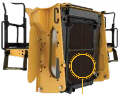
Le système de refroidissement à plan unique réduit la charge thermique et prolonge la durée de vie des composants
