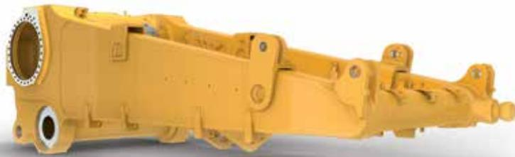
Penyempurnaan selubung dan rangka untuk meningkatkan umur fatigue
