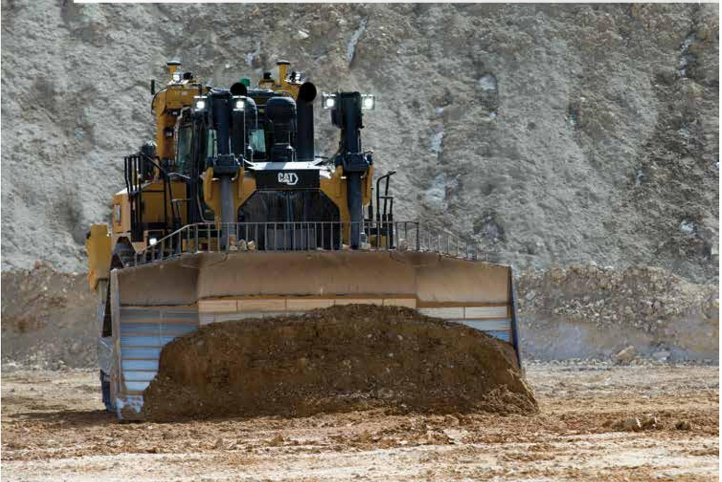
**OPSI BLADE** untuk D10 Opsi work tool tersedia untuk aplikasi yang memerlukan blade berkapasitas tinggi untuk material yang ringan.
