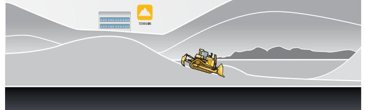
車載のガイダンスツールとリアルタイムフィードバックにより、整地用 MineStar Terrain は、鉋体、ベンチの高さ、サイクルタイム、切断および充填されたマテリアルの量を監視することにより、オペレータに機械効率を最大化するための情報を提供します。オフィスから、掘削/切崩し箇所、マテリアルの運搬量、十分に運搬したタイミング、運搬し過ぎた場合でさえオペレータに情報を伝達します。
