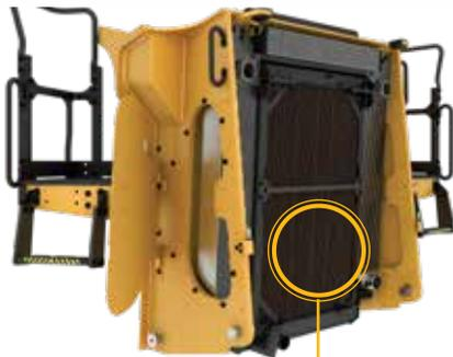
単一面冷却システムが熱負荷を低減するため、コンポーネントの寿命が延長
