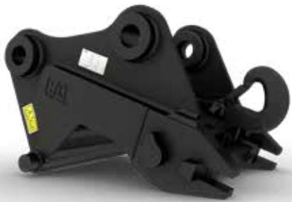
Attaches de pelle hydraulique
