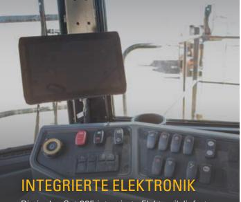
Die in den Cat 995 integrierte Elektronik liefert verschiedenste Informationen zum Einsatzort sowie zum Fahrer. Das Ergebnis dieser Integration ist eine intelligente Maschine und ein besser informierter Fahrer, die beide mit höchster Produktivität arbeiten können.
