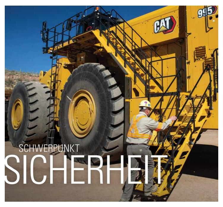
Von rutschfesten Oberflächen und Geländern bis hin zu modernsten Technologien zur Objekterkennung: Der 995 bietet sowohl den Fahrern als auch dem Wartungspersonal durch zahlreiche Funktionen ein sicheres und komfortables Arbeitsumfeld. Ein- und Ausstieg wurden verbessert, die Sichtbarkeit wurde optimiert und mehr Wartungsarbeiten können jetzt vom Boden aus durchgeführt werden.
