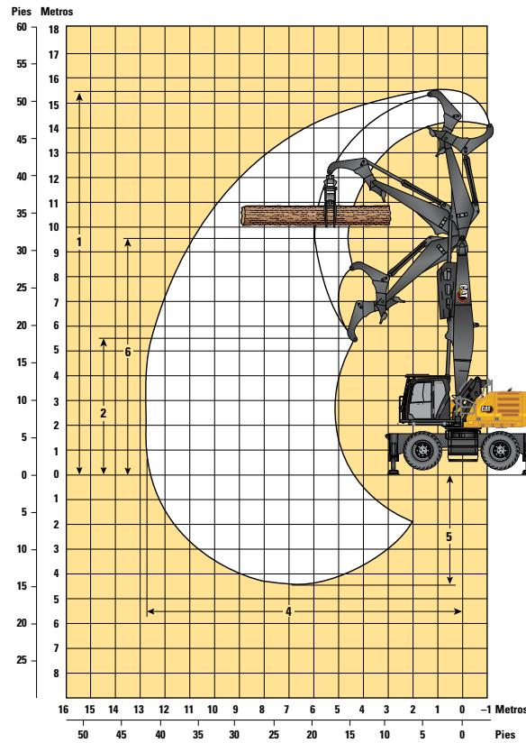
Altura máxima de la parte superior del nivel de los troncos: 11.000 mm (36'1")
