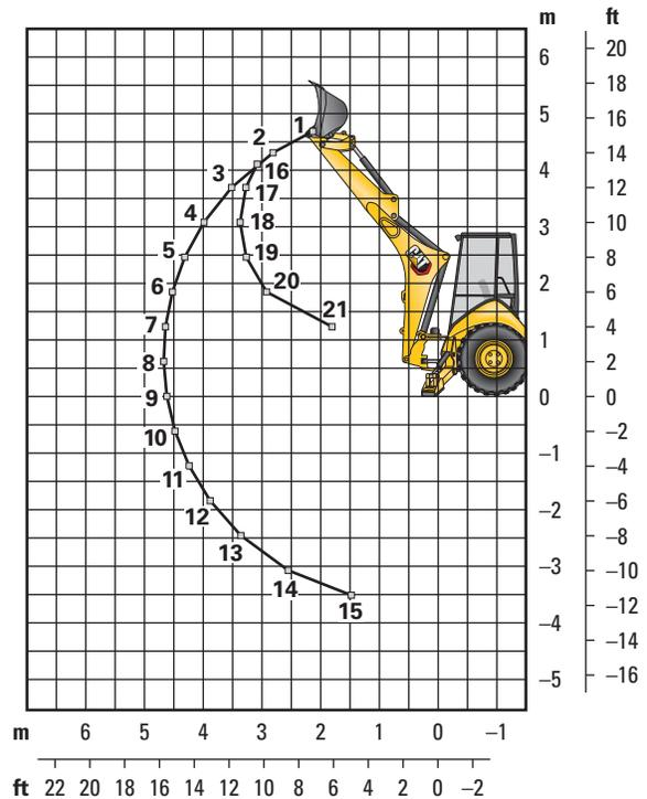
As Capacidades de Levantamento têm valores excedentes. Máquina equipada com Tração nas 4 Rodas, OROPS (Open Roll Over Protective Structure, Estrutura Protetora Aberta Contra Acidentes de Capotagem), caçamba de propósito geral de 0,96 m<sup>3</sup> (1,25 Yd<sup>3</sup>) e contrapeso de 227 kg (500 lb). O braço extensível inclui contrapeso de 485 kg (1.070 lb).
