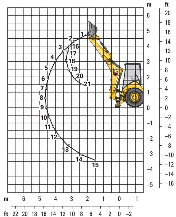
Las capacidades de levantamiento son valores de capacidad más allá del extremo de la máquina. Máquina equipada con tracción en las 4 ruedas, estructura OROPS, cucharón de uso general de 0,76 m<sup>3</sup> (1,0 yd<sup>3</sup>) y sin contrapeso. El brazo extensible incluye un contrapeso de 460 kg (1.015 lb).
