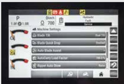
La función de control automático de la hoja de Terrain proporciona controles automáticos completos, carga completa de la hoja y protección de sobrecorte integrada en el sistema de control de la máquina de los Tractores Topadores D11. Estas herramientas agilizan el trabajo, disminuyen el consumo de combustible y minimizan el sobrecorte, el llenado en exceso y la remanipulación.
