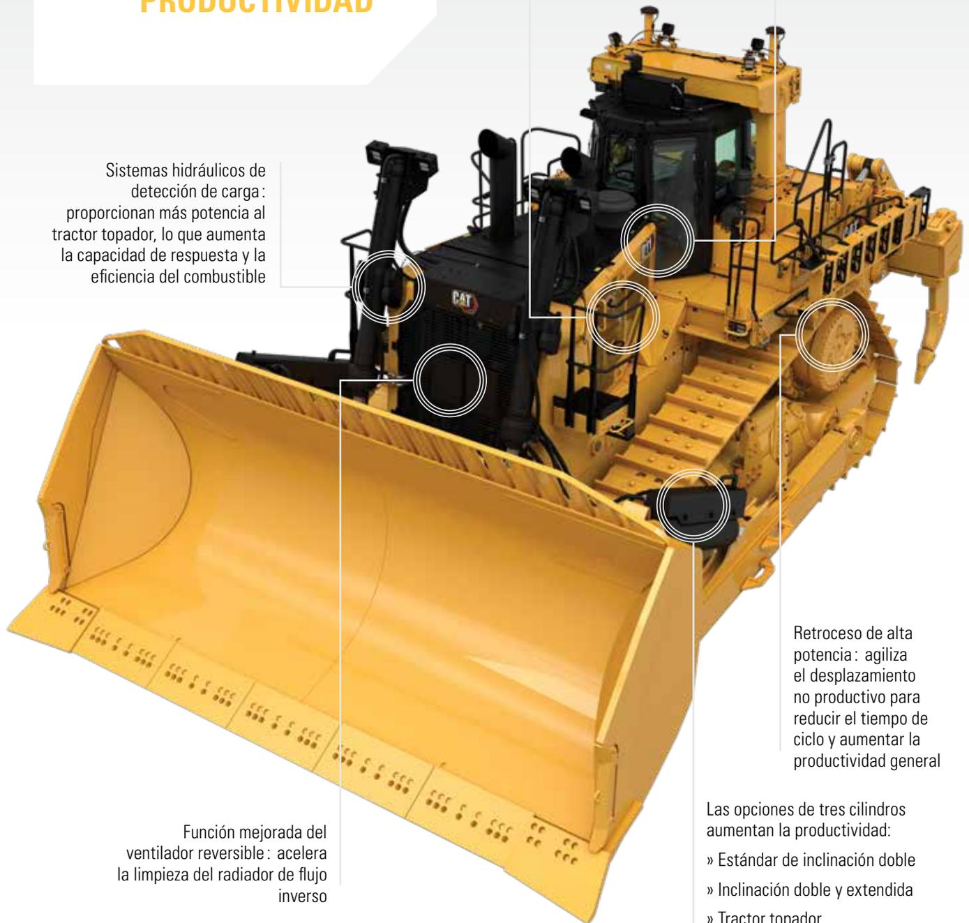
Función mejorada del ventilador reversible: acelera la limpieza del radiador de flujo inverso
