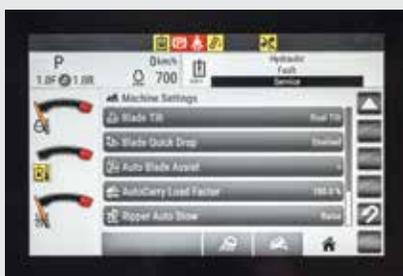
La fonction de commande automatique de lame de Terrain offre une entière automatisation, une charge complète de la lame et une protection contre les excès de coupe intégrés dans le système de contrôle de la machine des tracteurs D11. Ces outils accélèrent le travail, réduisent la consommation de carburant et minimisent les excès de coupe, les débordements et les manipulations inutiles.
