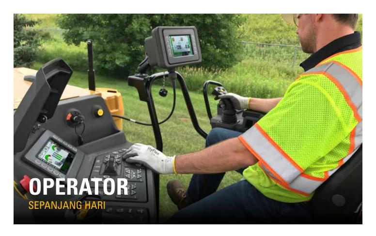
Area kerja dapat dikonfigurasi untuk posisi bekerja dan preferensi operator. Tampilan layar sentuh memberikan akses ke cluster pengukur, informasi pengoperasian, feed kamera jarak jauh, kontrol alat berat, dan diagnostik.
