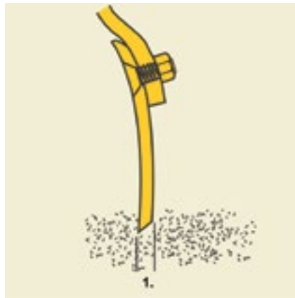
Нож отвала, вид сбоку 1. Режущая кромка
