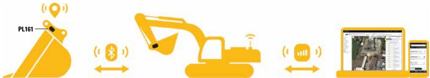
PL161 envoie un signal au récepteur Bluetooth ou au PL542 de la machine.
