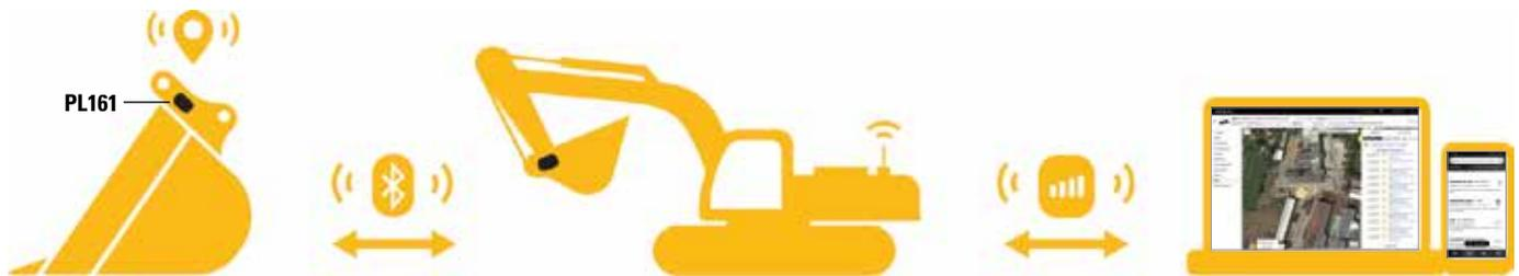
Das PL161-Modul sendet ein Signal an den Bluetooth-Empfänger oder PL542 der Maschine.
