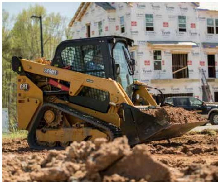
让履带的整个长度保持在地面上可提供最大牵引力，并可以利用机器的悬架。使用浮动功能通过装载机臂进行回拖可以获得出色的结果，并最大限度地提高底盘系统的使用寿命。如果需要更大的向下压力，借助 CTL 悬架系统可增加向下压力而不将底盘系统抬离地面。仅施加平整表面所需的压力。
