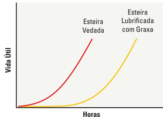
**Com a Esteira Lubrificada com Graxa, o desgaste interno é eliminado até que a graxa dissipe do conjunto da tubulação.**
