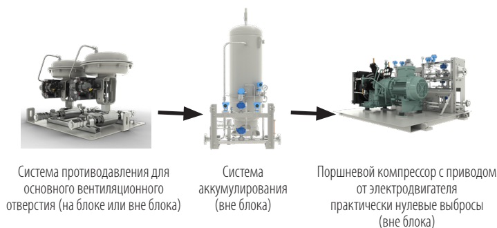
Рис. 1. Система рекомпрессии с сухим уплотнением
