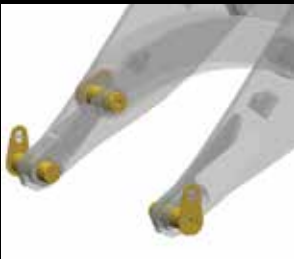
Bolzenaufhängung 910, 914/914K, 920/920K
