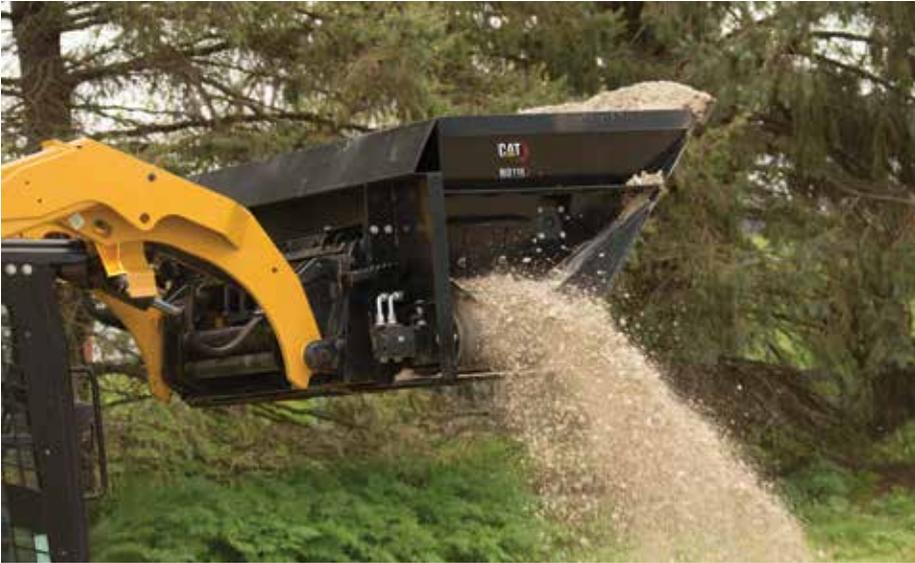
Les **Godets à déchargement latéral** permettent de collecter et décharger de la sciure, du paillis, de la paille et du sable dans les granges, les stalles et les vergers, remblayer les strates superficielles ou le gravier fin dans des tranchées et répandre l'ensilage. La conception de déchargement à droite ou à gauche élimine le recours à des manœuvres compliquées, ce qui permet de gagner du temps. 📷 (Sciure seulement)
