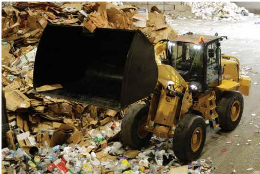
La conception du **Godet Normal GP série Performance** adapte sa forme à la timonerie de la machine, ainsi qu'à ses capacités de charge, de levage et d'inclinaison. Bénéficie d'un fond plus grand, d'une gorge ouverte et de barres latérales incurvées qui accroissent les angles de redressement pour un chargement de matière parfait et une augmentation des facteurs de remplissage de 115 % en plus des capacités indiquées.
