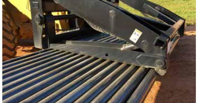
**Rohr- und Mastgabeln** werden für den Einsatz bei Öl- und Gasfeldbohrungen, den Bau von Rohrleitungen und oberirdischen Versorgungsleitungen entwickelt und gebaut.
