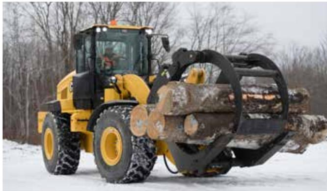
**Sortiergreifergabeln** sind für zahlreiche Anwendungen im Rundholz- und Schnittholzumschlag entwickelt worden. Die Sortiergreifergabeln sind unter anderem darauf ausgelegt, Baumstämme von Poltern abzuheben oder LKW zu entladen.
