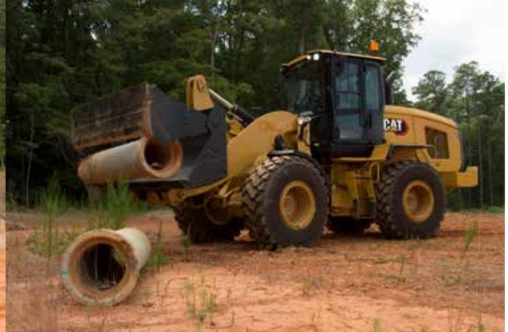
**Kombischaufeln** für kleine Cat®-Radlader sind überaus vielseitig und ermöglichen es dadurch, zahlreiche Aufgaben mit nur einem Anbaugerät zu erledigen. Diese Schaufel ist ideal für den Materialumschlag, zum Abziehen, Planieren und Greifen unregelmäßig geformter Objekte.
