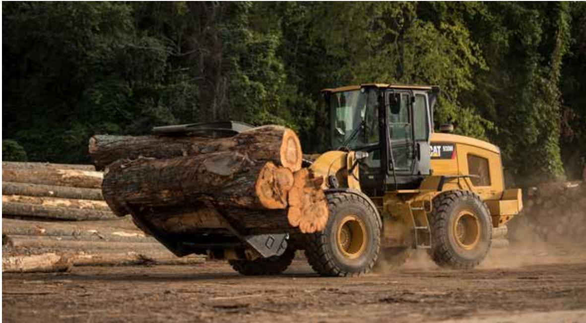
**Millyard Gabeln** maximieren die Fähigkeit, die Gabel bei jedem Durchgang zu füllen. Effizientes Be- und Entladen von Lkws, Sortieren von Stangen- und Schnittholz auf dem Lagerplatz, Beschicken von Sägewerken sowie Umschlagen langer oder sperriger Materialien.
