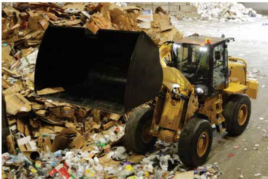
O projeto das **Caçambas de Propósito Geral da Série Performance** equilibra o formato da caçamba em relação às capacidades de articulação, peso, levantamento e inclinação da máquina. Os benefícios de um piso mais longo, garganta aberta e barras laterais arredondadas aumentam os ângulos de inclinação para trás para um carregamento perfeito do material e aumentam os fatores de enchimento em até 115% além das capacidades especificadas.
