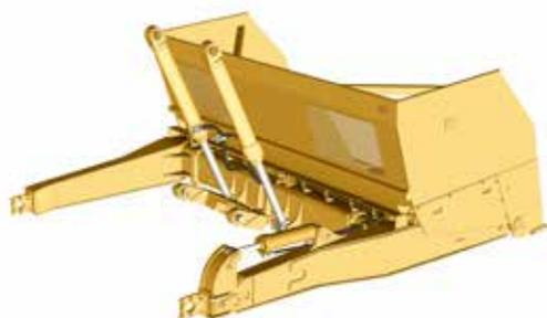
Ambos palas vienen con dos cilindros de levantamiento para ofrecer mayor capacidad de levantamiento. El sistema estabilizador integrado garantiza que la pala permanezca estable y centrada en la máquina. La función de inclinación de la pala se incluye de manera estándar y proporciona  $\pm 15$  grados de inclinación para mantener las condiciones de pendiente y la seguridad de operación.
