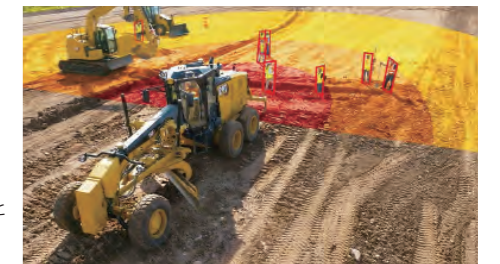
スマートカメラテクノロジーにより、作業員と背景の物体を区別して警告を発します。他の機械や障害物には反応しません。
