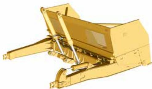
Для повышения грузоподъемности оба ковша оснащены двойными цилиндрами подъема. Встроенная система стабилизатора гарантирует устойчивость ковша и его расположение по центру машины. Функция наклона ковша входит в стандартную комплектацию машины и обеспечивает наклон в  $\pm 15$  градусов для поддержания уклона и безопасности работы.
