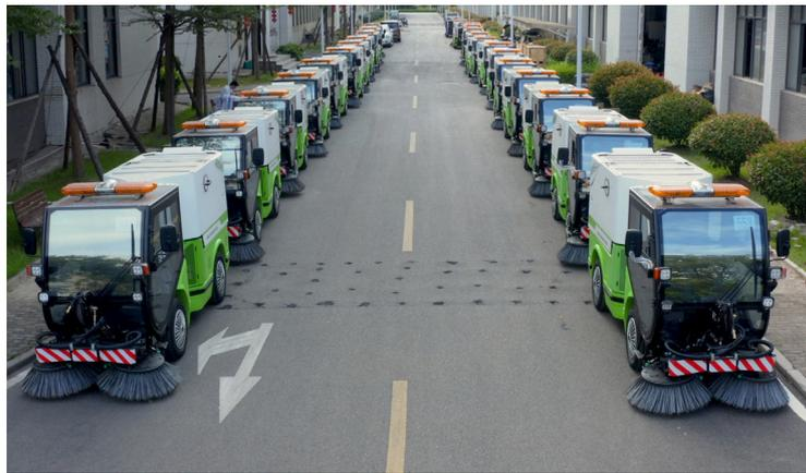
RG-8240 具备独特的特性组合, 包括铰接式有空调全景玻璃驾驶室、不锈钢收集箱和“无配重”扫刷系统, 能够提高清洁效率并延长扫刷寿命。设备主要功能全部采用先进的液压技术, 包括步进驱动装置、转向系统、风扇驱动装置、扫刷驱动装置和集尘箱升降机。
