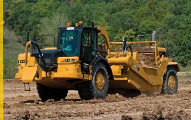
الاختيار الرئيسي لنقل المواد في موقع أعمال الحفر هو كاشطة الجرار بعجل Cat® 627. تم تصميم هذه الماكينة، التي تعمل بالطاقة المزدوجة لزيادة مقاومة التدحرج واجتياز الميول الحادة، لتعمل بفعالية في مجموعة كبيرة من الظروف وأنواع المواد. سواء كنت تتحرك عبر الرمال أو الأوحال أو الصخور المتكسرة، فهي مصممة خصيصاً لتلائم احتياجات ماكينة نقل التربة في العمل اليوم وغداً.
