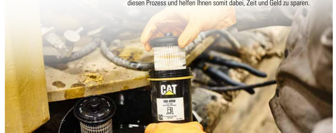
Cat-Kraftstofffilter wurden so entwickelt, dass sie Schmutzstoffe aufnehmen und zurückhalten, wodurch die Lebensdauer von Systemkomponenten verlängert und die Motorleistung geschützt wird. Für Sie bedeutet dies geringere Vorhalte- und Betriebskosten. Da das Filtergehäuse wiederverwendet werden kann, muss nur die Filterpatrone ausgetauscht werden, was die Servicefreundlichkeit verbessert und den anfallenden Abfall vermindert.
