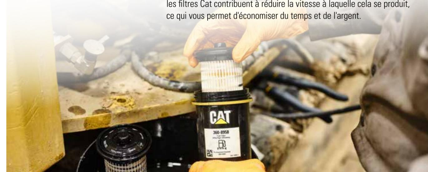
Les filtres à carburant Cat sont conçus pour bloquer et retenir les contaminants afin d'augmenter la durée de vie des composants et de protéger les performances du moteur, ce qui permet de réduire les coûts d'exploitation et d'entretien. Le boîtier du filtre étant l'enveloppe, seule la cartouche doit être remplacée, ce qui facilite l'entretien et réduit les gaspillages.
