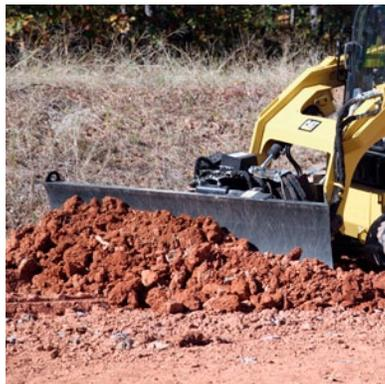
Le lame apripista Cat sono progettate per il livellamento preliminare e la finitura di precisione con composizioni miste di terriccio e ghiaia e nella spianatura superficiale. Grazie alle sei modalità, le lame apripista sono più adatte delle lame angolabili a lavori di finitura di precisione in applicazioni d'ingegneria civile e architettura paesaggistica.
