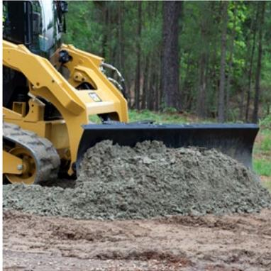
Le lame angolabili Cat sono attrezzature utili in un'ampia gamma di applicazioni come la movimentazione di terriccio, ghiaia, scarti zootecnici e neve. Sono altresì utili anche in attività di finitura di precisione in progetti d'ingegneria civile e architettura paesaggistica.
