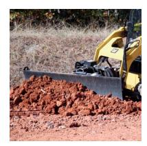
As Lâminas Cat são projetadas para movimentação bruta e de acabamento em terra, cascalho e para trabalhos leves. Com seus 6 tipos de habilidades, as lâminas são mais indicadas para trabalho de nivelamento final em aplicações de construções e paisagismo do que as lâminas anguláveis.
