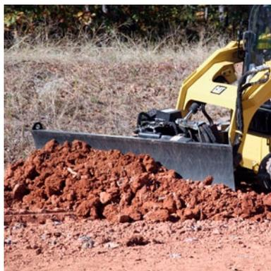
Catドーザ・ブレードは、土、砂利の荒整地や仕上げ整地、軽負荷の押土作業用に設計されています。ドーザ・ブレードには6ウェイ機能が備わっており、アングル・ブレードよりも建設や整地用途での仕上げ整地作業に適しています。
