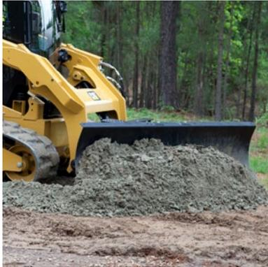
Catアングル・ブレードは、土、砂利、家畜の排泄物、雪の移動など多様な用途に役立つワーク・ツールです。また、建設や整地用途での仕上げ整地作業にも役立ちます。
