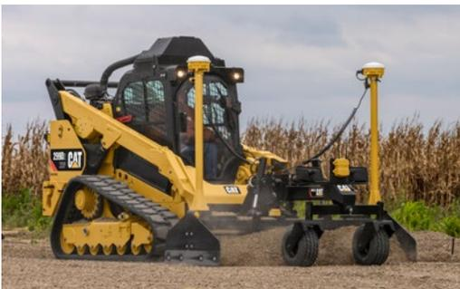
**Einfaches oder duales 3D-GPS:** GPS-Systeme können mit anderen Maschinen auf der Baustelle kombiniert werden und bieten volle Planierfähigkeit. Sicht auf den Himmel ist für die Funktionalität der GPS-Systeme erforderlich. Standardhubmasten in dieser Konfiguration müssen gegen steifere Befestigungen ausgetauscht werden.
