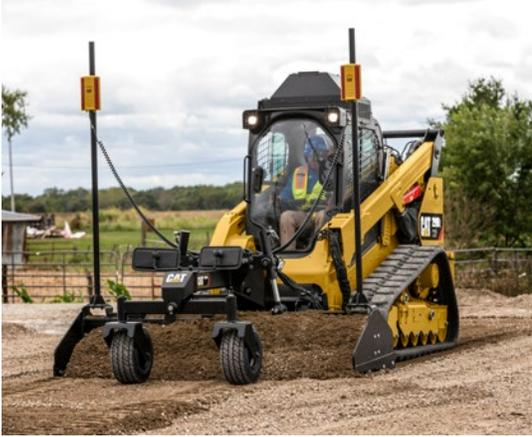
**Zwei Laser mit standardmäßigen festen Hubmasten:** Duale Neigungssteuerung oder Neigungs- und Höhensteuerung. Hohes Maß an Genauigkeit für Arbeit auf Ebenen, Neigungen und Feinplanieren.
