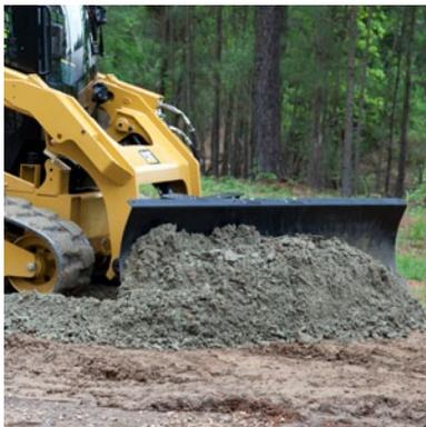
Поворотные отвалы Cat являются навесным оборудованием, которое может использоваться в различных условиях для перемещения грунта, гравия, животноводческих отходов и снега. Они также будут полезными при окончательном профилировании на строительных площадках и в ландшафтных работах.
