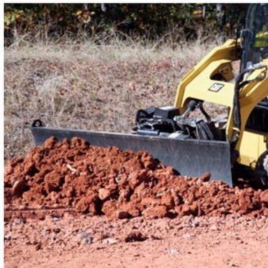
Les lames de refoulement Cat sont conçues pour le nivellement brut et de finition dans les saletés et le gravier, et pour des applications de refoulement légères. Grâce à leurs six fonctionnalités, les lames de refoulement sont plus adaptées que les lames orientables aux travaux de nivellement de finition dans les applications de construction et d'aménagement paysager.
