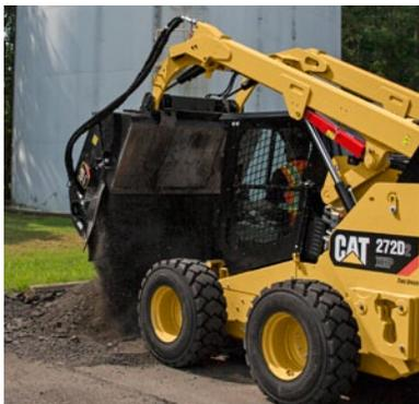
**Усиленная и изогнутая конструкция верхней части мусоронакопителя из высокопрочной стали**
