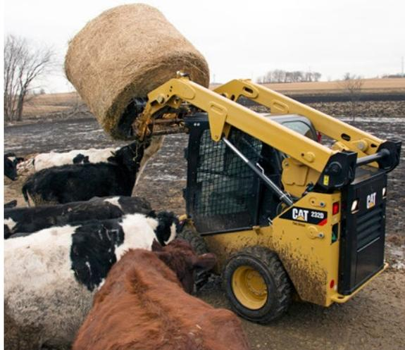
在农业及园林施工应用场合中，Cat® 捆叉用于装载和搬运圆形和方形的成捆物料。捆叉附件提供最佳的刚度和负载能力，拥有长久的使用寿命。
