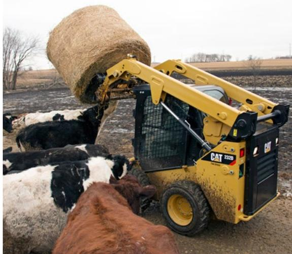
Cat®ベールスピアは、農業および整地用途でロール型と角型のベール状資材の積み込みと運搬用に使用されます。ベールスピアアタッチメントは優れた剛性と最適の容量を確保し、長い耐用年数を達成します。
