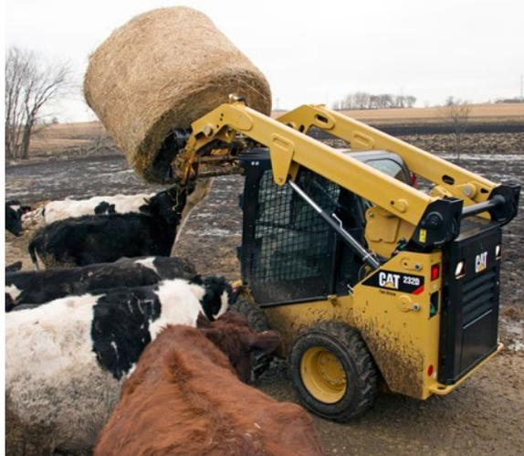
Gli arpioni per balle Cat® vengono utilizzati per caricare e trasportare materiali in balle rotonde e quadrate nelle attività agricole e di architettura paesaggistica. Gli arpioni per balle, in grado di offrire rigidità e capacità ottimali, sono progettati per garantire una durata elevata.
