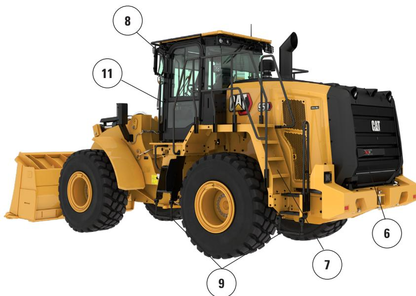
6. Contacteur de neutralisation du frein de stationnement et d'arrêt du moteur au niveau du sol
