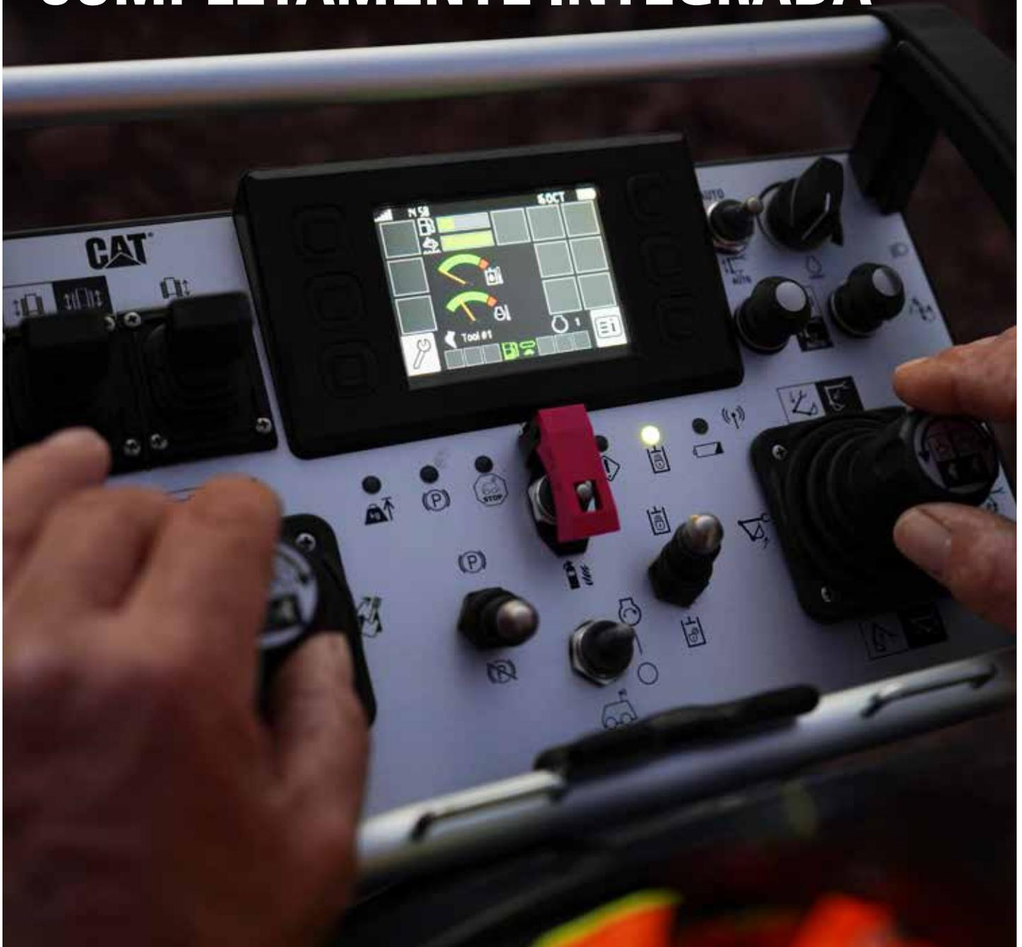
Los controles de Cat Command Console y Cat Command Station están totalmente integrados con los sistemas electrónicos e hidráulicos de la excavadora.
