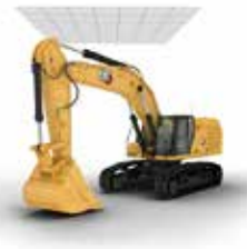
电子墙壁限高
