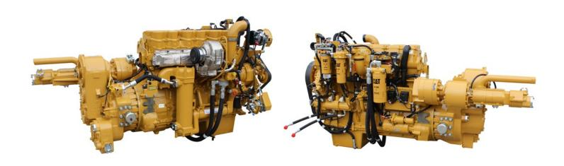
Cat C15 发动机可在挖掘、运输和穿越陡坡时提供无与伦比的牵引力。扭矩储备与变速箱换档点高效配合,可以实现最高效率和更短的循环时间。机械驱动式电子单体喷射(MEUI™)高压直喷燃油系统以电子方式监控操作员的需求和传感器的输入,从而优化发动机的性能。空对空后冷系统可将密度更大、温度更低的空气压入气缸,使燃油燃烧更充分,因此油耗更低,排放量更少。油冷式活塞提高了散热,从而延长了活塞的使用寿命。曲轴采用锻造和感应淬火工艺,长久耐用。
