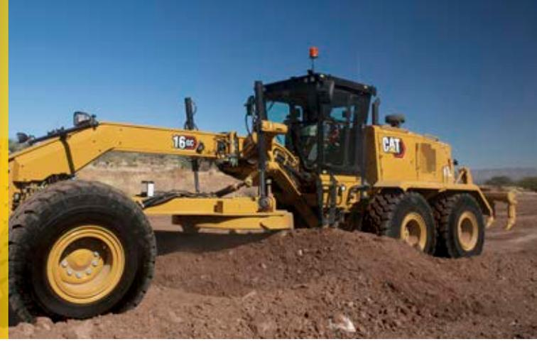
تتميز ماكينة التسوية التي تعمل بموتور Cat® 16 GC بسهولة التشغيل والصيانة. تحكم في الشفرة بدقة متجانسة باستخدام أدوات التحكم في عجلة القيادة والذراع من داخل الكابينة. إن المروحة التي تعمل عند الحاجة والوضع الاقتصادي القياسي (ECO) يعملان على تقليل استهلاك الوقود في حين يؤدي الوصول السهل إلى نقاط الصيانة إلى تسهيل الخدمة وتسريعها. ليس بالضرورة أن تتوفر كل المزايا في جميع المناطق. استشر وكيل Cat المحلي بشأن المواصفات المتاحة في منطقتك.
