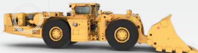
Cabine intégrale ROPS et FOPS, montée de manière élastique sur le châssis
