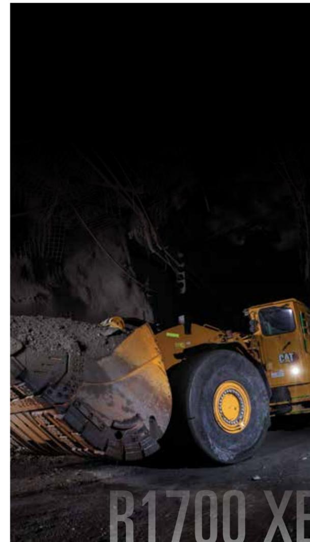
随着矿挖得越来越深，开发成本也随之增加。获得清洁凉爽的空气越发困难，相应花费也越来越高。我们认识到深层井下矿场通风困难，需要使用蓄电池电动车辆，因此在试验场设施中开始在 R1300G 上使用概念验证系统。这款铲运机在实际矿场中经过了 800 多个小时的验证，充分展现出我们的车载蓄电池充电系统拥有的潜力。
