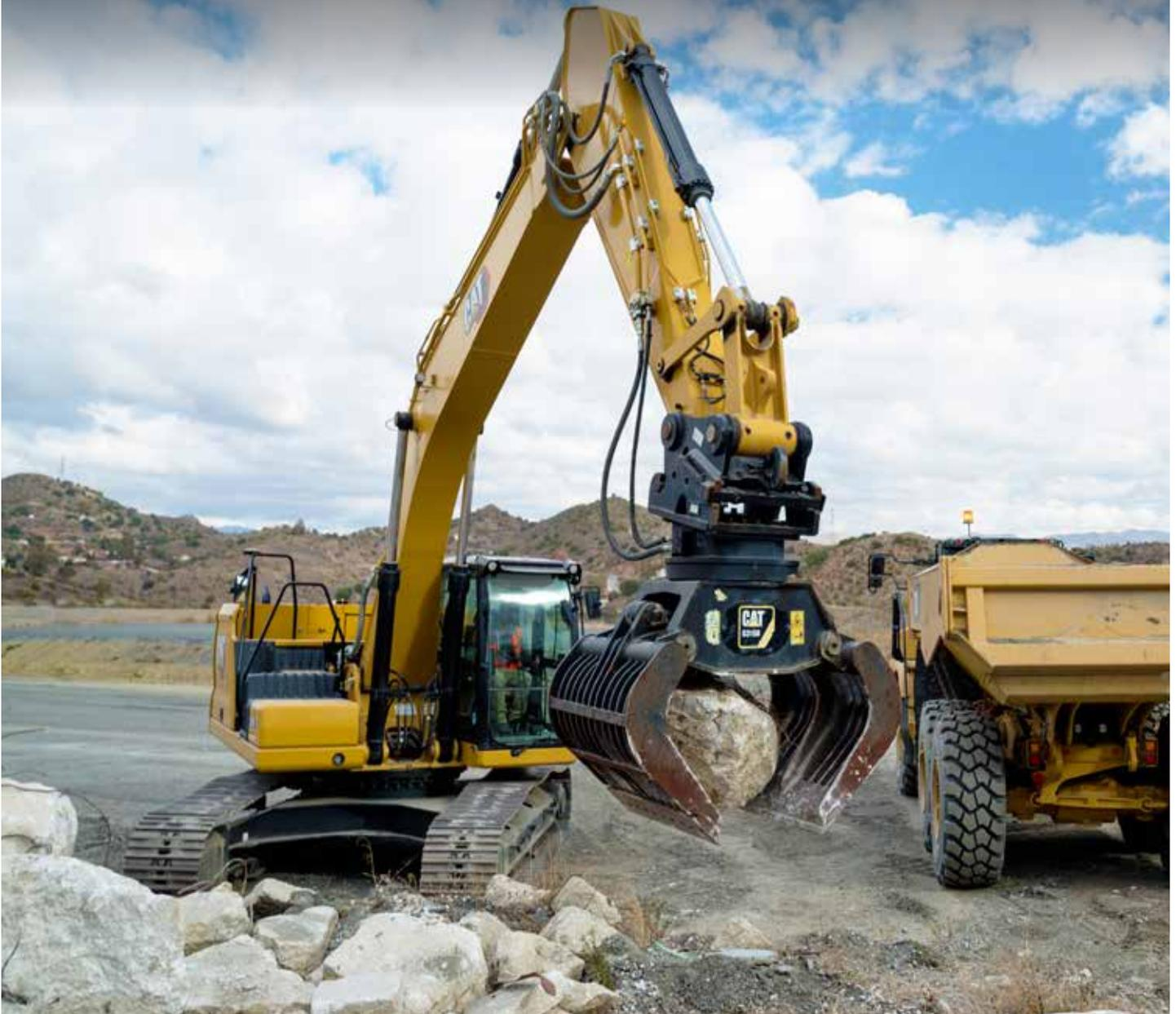
La tecnologia Cat Payload consente la pesatura a bordo del carico utile e fornisce non solo preziosi dati di misurazione della produzione e di tracciamento dei materiali, disponibili per le singole macchine, ma anche informazioni utili sull'efficienza operativa a livello di flotta.
