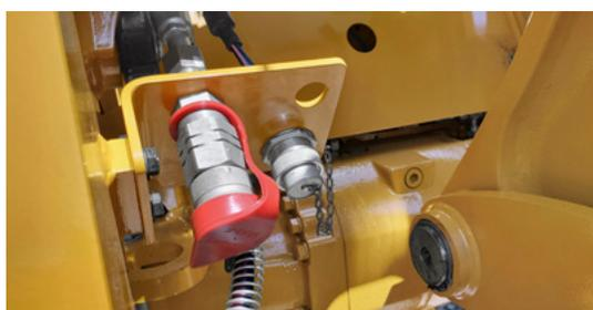
Les circuits hydrauliques auxiliaires sont disponibles en mode par pression ou à visser pour les raccords à vos équipements Cat Work Tools préférés. Les commandes des outils électriques depuis la cabine offrent des options uniques lorsque cela est nécessaire.
