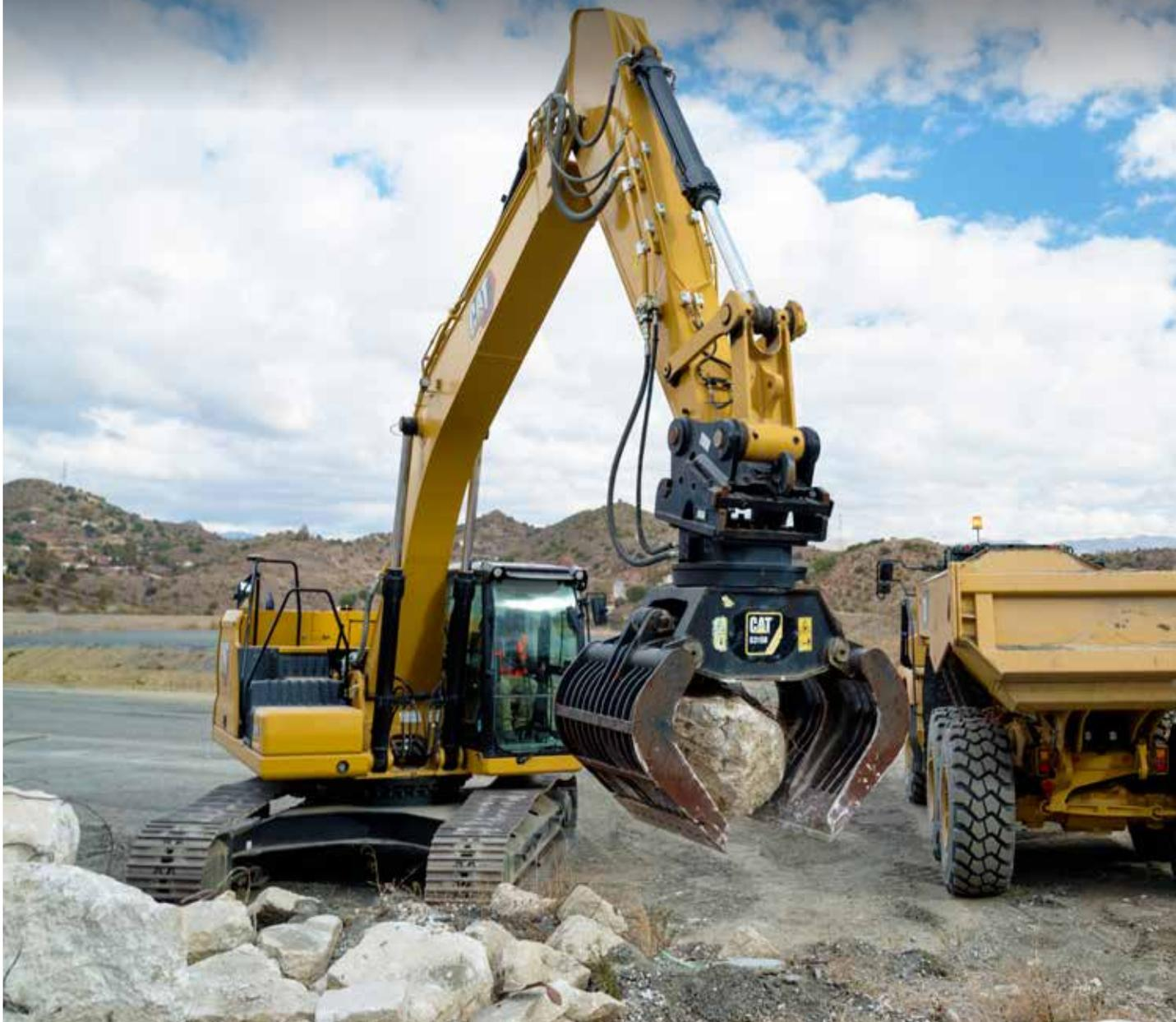
Технология Cat Payload определяет массу перемещаемой полезной нагрузки и предоставляет ценные данные о материале и производственных показателях. Доступны данные для отдельных машин, на основе которых также можно получить полезные сведения об общей производительности парка.
