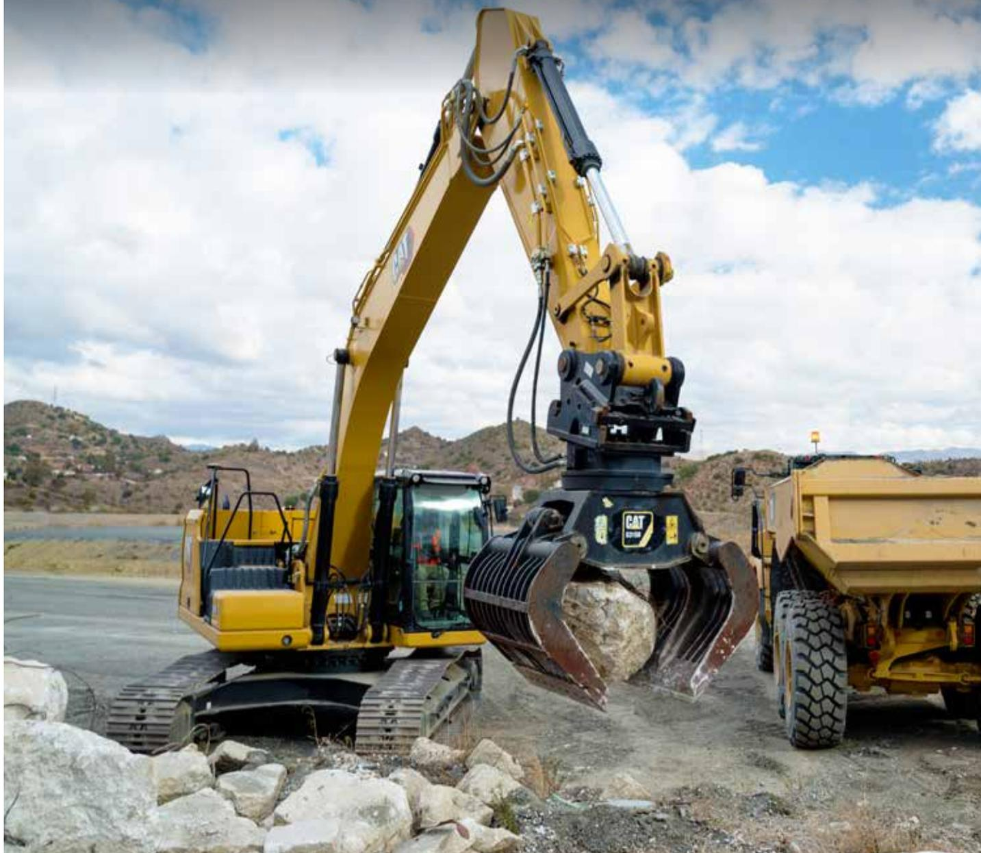
Die Cat Payload Technologie gewährleistet die Nutzlast-Ermittlung vor Ort zusammen mit nützlichen Produktionsmess- und Materialverfolgungsdaten. Diese Daten sind für einzelne Maschinen verfügbar und können ebenfalls sinnvolle Betriebsleistungsdaten für die gesamte Flotte bereitstellen.
